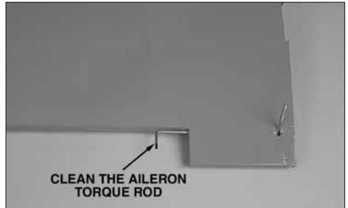
CLEAN THE AILERON TORQUE ROD
