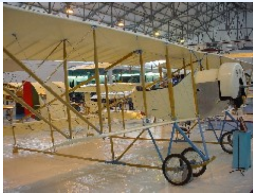
Un Caudron GIII (en cours de peinture des parties bleues claires; le scotch papier de masquage y est encore).
