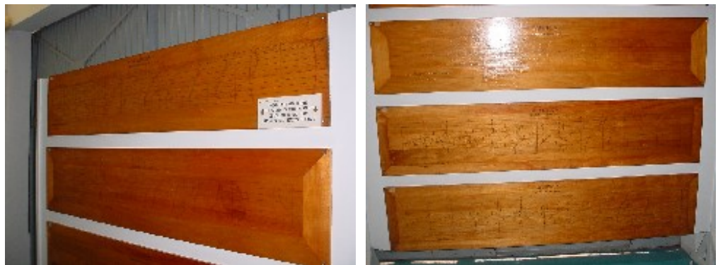
Détail intéressant, ces planches sont des plans de coupe pour réaliser des hélices en bois lamellé collé pour des modèles tels que des Potez ou des CAMS 37.
